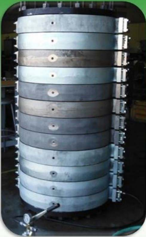
การทดสอบด้วยแรงดันน้ำ
